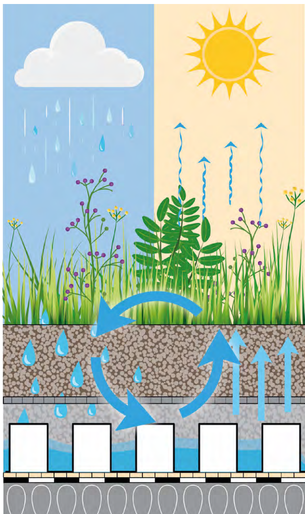
Schematische Darstellung des Wasserkreislaufs einer Dachbegrünung.
