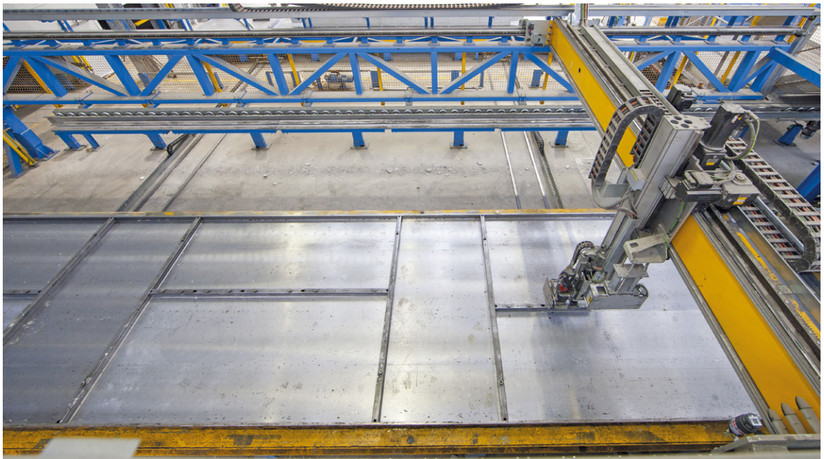
Moderne Anlagen sorgen bei der Betonfertigteilerstellung für hohe Maßgenauigkeit und kontrollierte Produktionsbedingungen.
