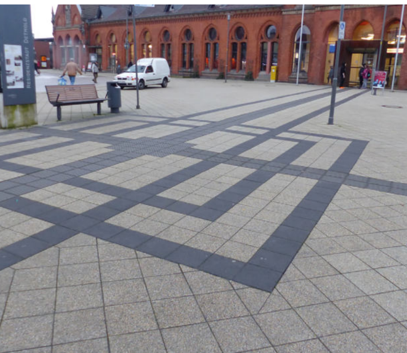
Betonsteine mit TiO 2 -Beimischung (Bahnhofsvorplatz Detmold).
