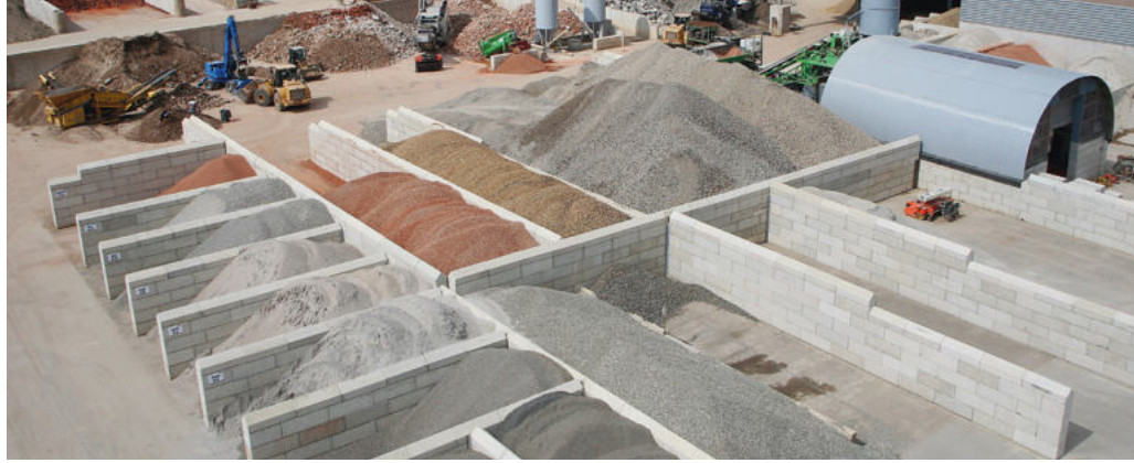
Baustoffrecyclinganlage: Im Vordergrund Lager mit verschiedenen Recycling-Produkten, im Hintergrund unterschiedliche mineralische Abfälle (Böden, Ziegel- und Betonbruch), die differenziert aufbereitet werden.
