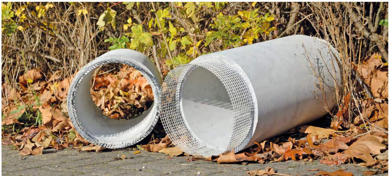
Textilbetonstrukturen mit integrierter Leckagesensoren.
