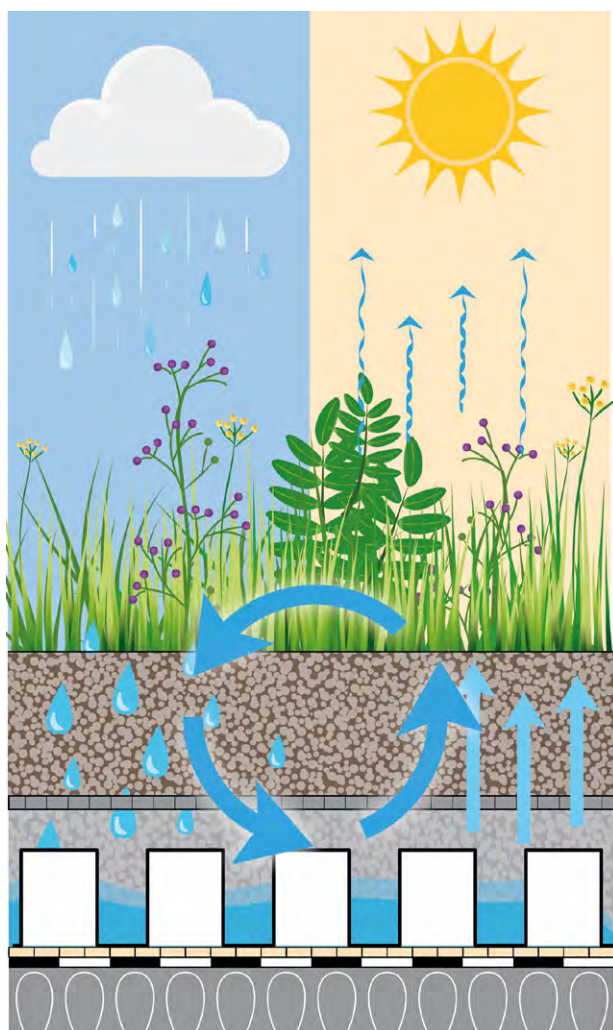
Schematische Darstellung des Wasserkreislaufs einer Dachbegrünung.
