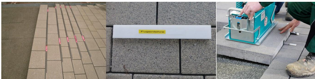
Bild 4: Beispiel für unterschiedliche Fugenlehren für Pflasterdecken und Plattenbeläge (v. l. n. r.: lange Schiene, kurze Schiene, T-Stück) (Quelle: FGSV)
