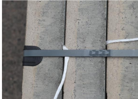
Abbildung 6: Kantenschutz unter Kunststoffumreifungsband und Kordel als Zwischenlage (Quelle: SLG)
