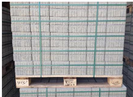
Abbildung 3: Horizontale und vertikale Umreifung mit Kunststoffbändern (Quelle: SLG)
