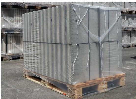
Abbildung 2: Palette, Umreifung, Schumpfhaube und Kordeln als Zwischenlage (Quelle: SLG)
