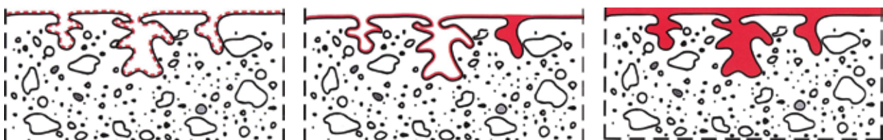
Bild 4: Schematische Darstellung der Oberflächenschutzsysteme Hydrophobierung (links), Imprägnierung (Mitte) und Beschichtung (rechts) (Quelle: Remei)
