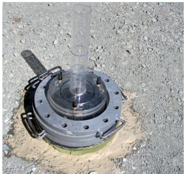
Bild 24: Bestimmung des Infiltrationsbeiwertes auf einer Tragschicht ohne Bindemittel (in situ) mit dem modifizierten Standrohr-Infiltrrometer nach den TP Gestein-StB Teil 8.3.2
