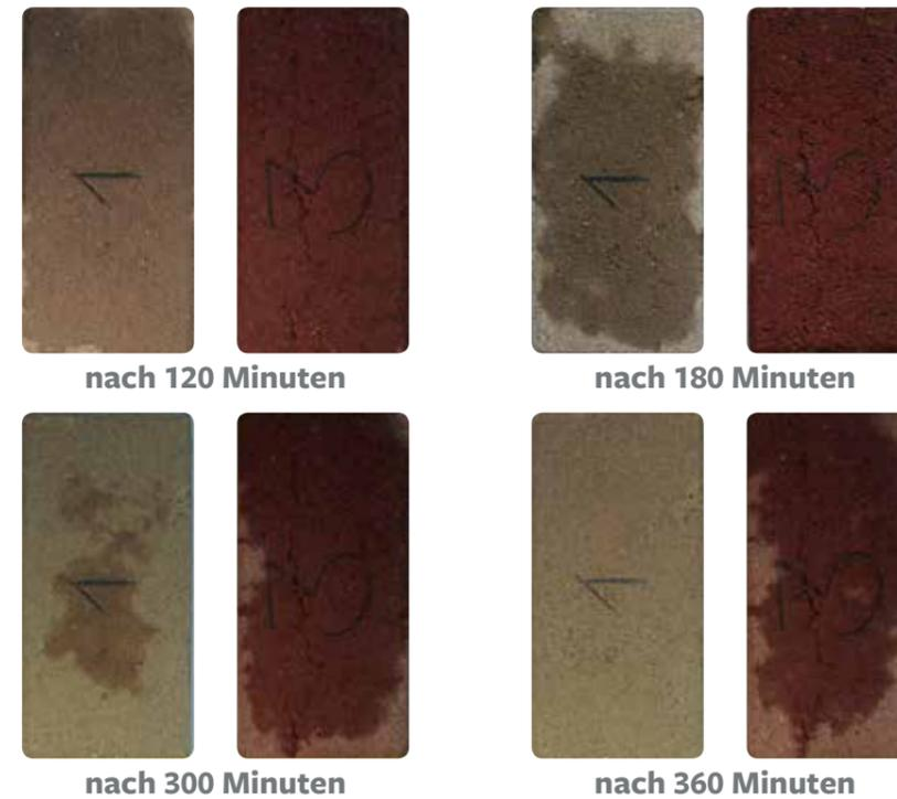
Abbildung 6: Abtrocknungsverhalten eines wassergesättigten Vorsatzbetons von Betonpflastersteinen im Laborversuch ( $\vartheta = 20\text{ }^\circ\text{C}$ ,  $\varphi = 45\%$ ). Probe Nr. 1, Farbe Grau,  $w_A = 6,0\text{ M.-%}$ ; Probe Nr. 3, Farbe Rot,  $w_A = 8,1\text{ M.-%}$ . FOTOS: MENTLEIN
