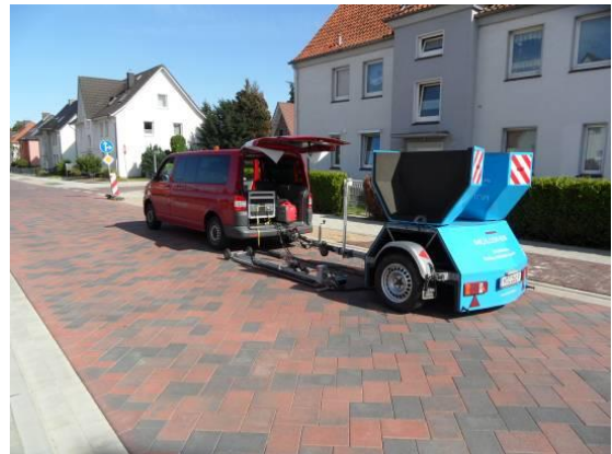
Abbildung 1: CPX-Messsystem auf einer der untersuchten Messstrecken.
