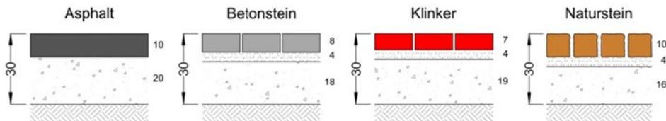
Nicht erneuerbarer Primärenergie für die untersuchten Oberbaukonstruktionen für einen Gehweg (Werte je m<sup>2</sup> Verkehrsflächenbefestigung)
