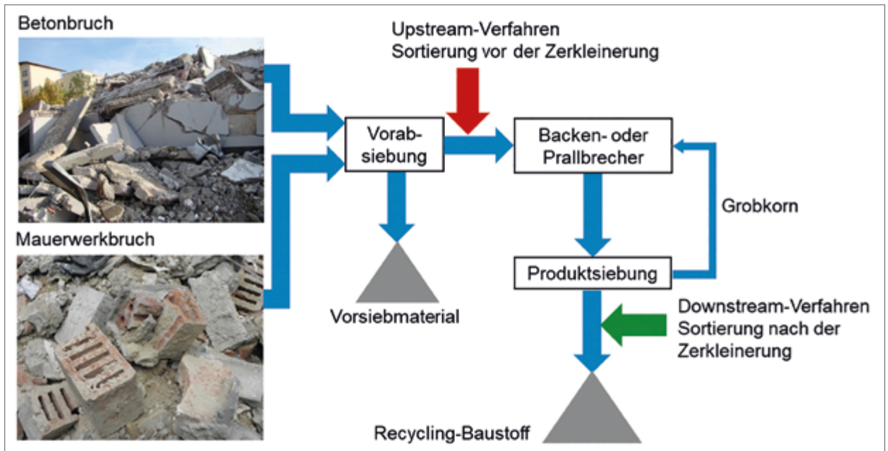
Einordnung der Sortierverfahren in den Verfahrensablauf.
